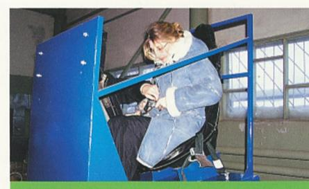
Устройство для моделирования столкновения
