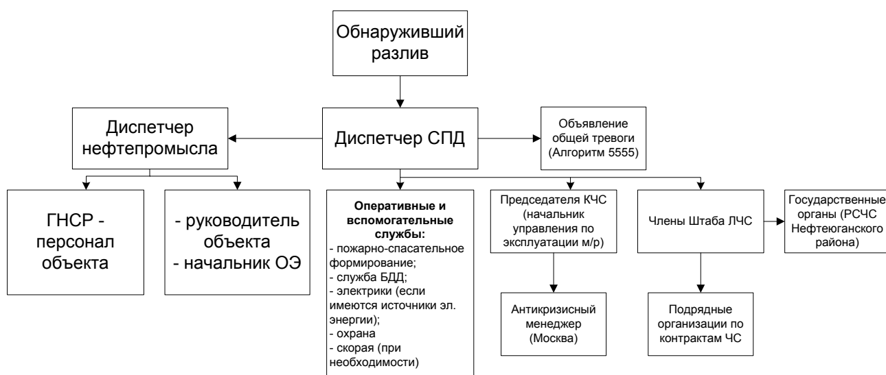
Рис 2. Порядок оповещения при разливе нефти на месторождении
