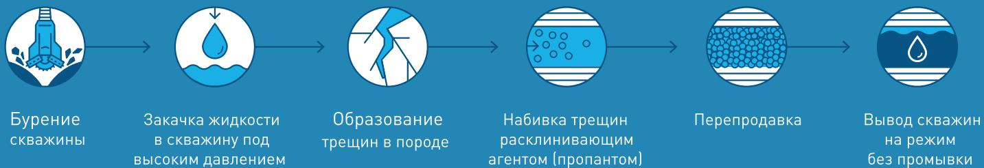
**Гидравлический разрыв пласта (ГРП)** – обработка пласта, при которой в горной породе создают трещины для повышения ее проницаемости.
